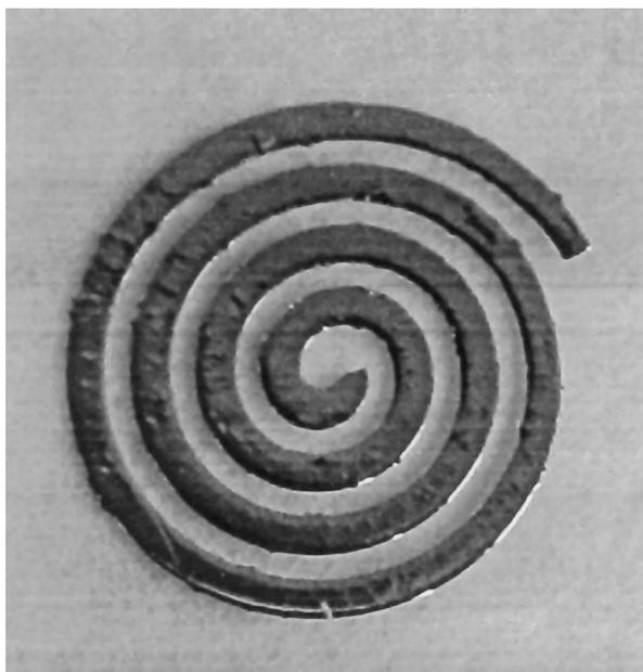
Рисунок 14 - Фоточувствительный детектор в форме спирали.
