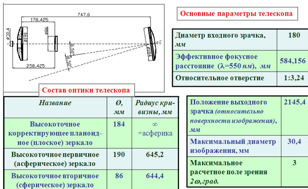
Рис. 2.9. Оптическая схема и основные параметры телескопа
