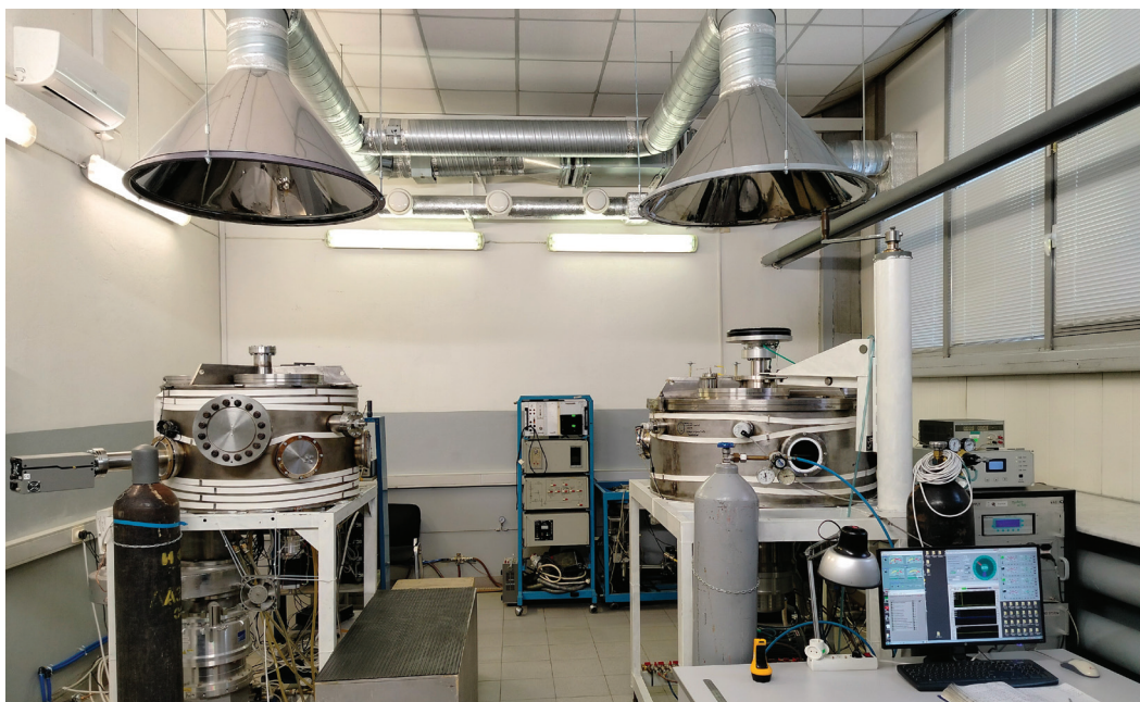
Установки магнетронного напыления Ве-содержащих многослойных рентгеновских зеркал
